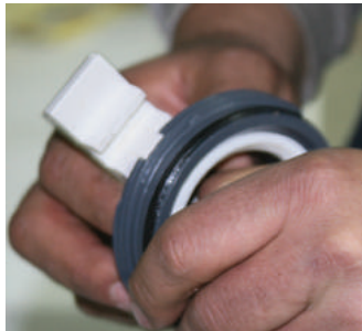
Dayama içindeki küre contası ile çıkartılır.
