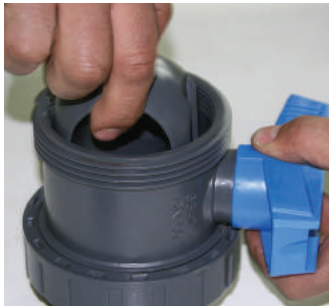
Küre iki kenarından parmaklarla tutularak çıkartılır. Burada vana altından küre itilerek çıkarma kuvvetine destek verilebilir.
