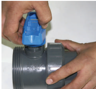
Kol çekilerek çıkartılır ve vanadan ayrılır.
