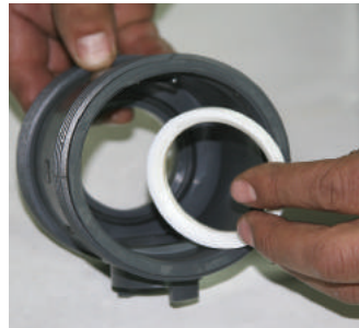
Gövde içindeki küre contası ile alınır.
