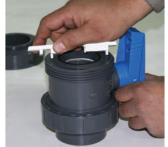
Vana kol kapağı altındaki tırnaklar sıkıştırma parçası yatağı (sekman) üzerindeki yuvalarına oturtulur.
