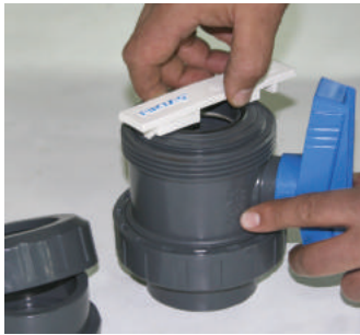
Sekman saat yönü tersine çevrilerek çıkartılır.
