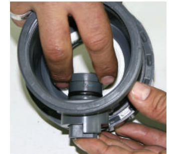
Pim dışardan içeriye doğru itilerek çıkartılır. Bu arada diğer el ile içerden tutulur. Yuvasından çıkan pim alınır.
