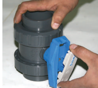
Küresel vana kol kapağı üzerinde açılmış kanalda tutularak çekilir ve çıkartılır.
