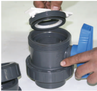
Sekman dişleri gövdeden kurtulduğunda kol kapağı ile birlikte ayrılacaktır.
